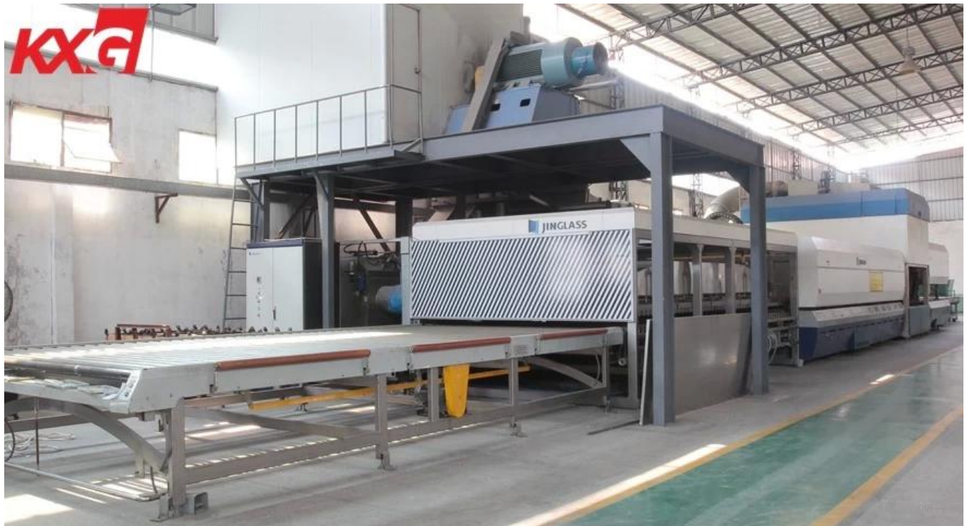
خط إنتاج الزجاج المقسى الشفاف الإضافي 8 mm
