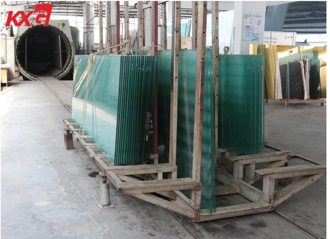
واضح زجاج مقسى الترقق البقاء الأوتوكلاف 8 ساعات 6 mm + 0.76 mm PVB + 6 mm
