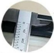
Sufficient thickness  $\geq 9\text{mm}$
