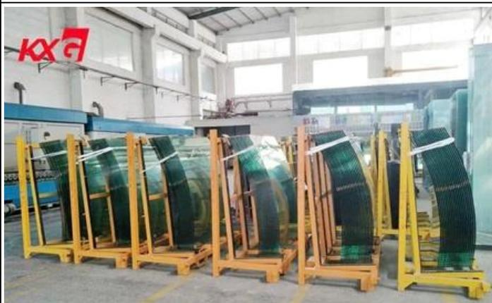
**Vidrio laminado curvo** es el vidrio más resistente porque las dos capas de vidrio están unidas permanentemente para formarlo. Incluso cuando el vidrio se rompe, permanece dentro de la laminación y no se rompe en pedazos.
