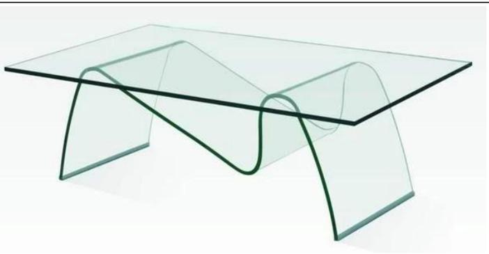
**Vidrio templado curvado** es fuerte y resistente al impacto porque el vidrio recocido se calienta a 700 ° C y se enfría rápidamente para inducir la resistencia del vidrio. Este tipo de vidrio se utiliza en escaleras, cabinas y otros interiores.
