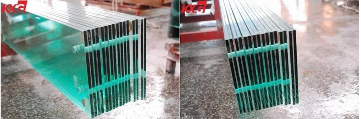
21.52 Vidrio laminado templado mm SGP, 10 + 1.52 Vidrio laminado templado mm +10 mm +10 mm, que es un tipo de vidrio de seguridad, fabricado por 2 piezas de vidrio templado mm de primera calidad unido con una película de 1.52 mm SGP. Con alta claridad y seguridad, ampliamente utilizado para ventanas y puertas resistentes a huracanes, ventanas antibalas, puentes, tragaluces, pisos y fachadas, etc.
