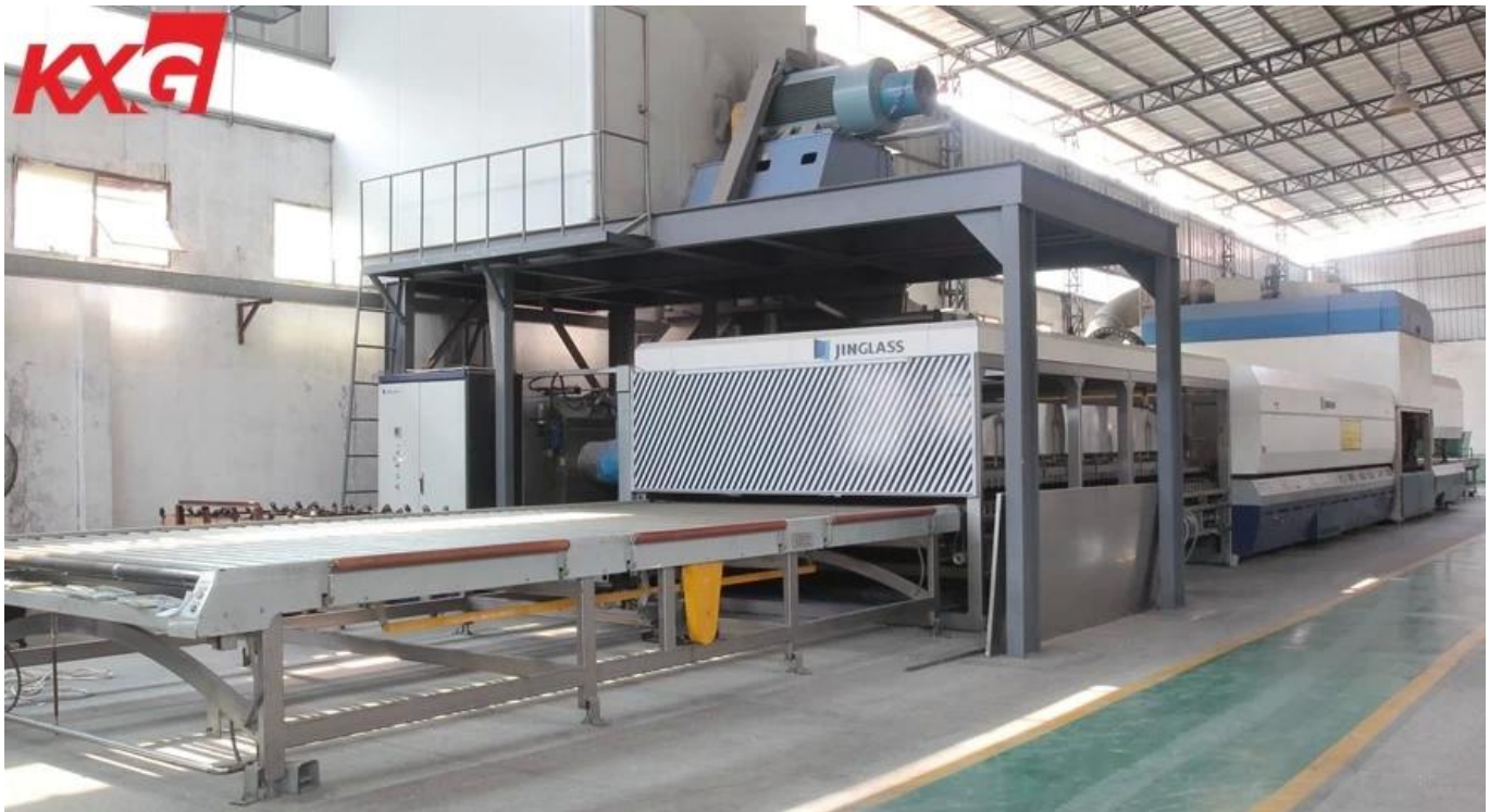
Línea de producción de vidrio templado extra claro 8 mm
