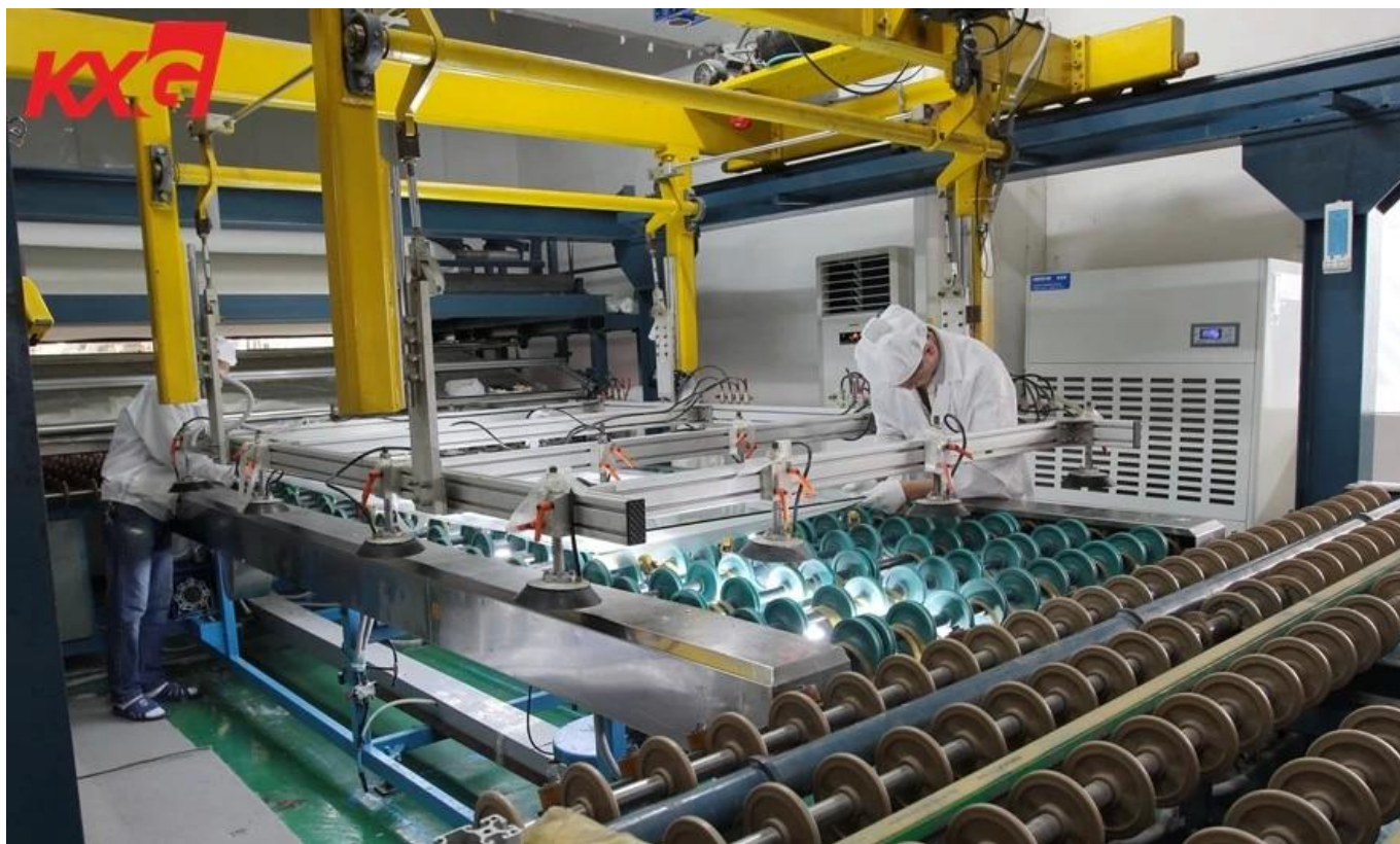
6 mm +0.76 mm PVB + 6 mm transparente templado vidrio laminado autoclave 8 horas
