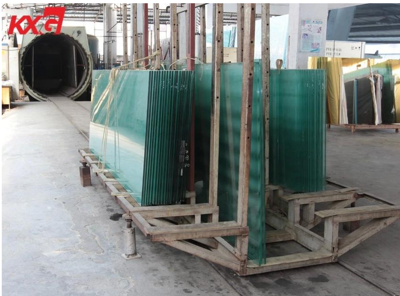
6 mm +0.76 mm PVB + 6 mm transparente templado vidrio laminado autoclave 8 horas
