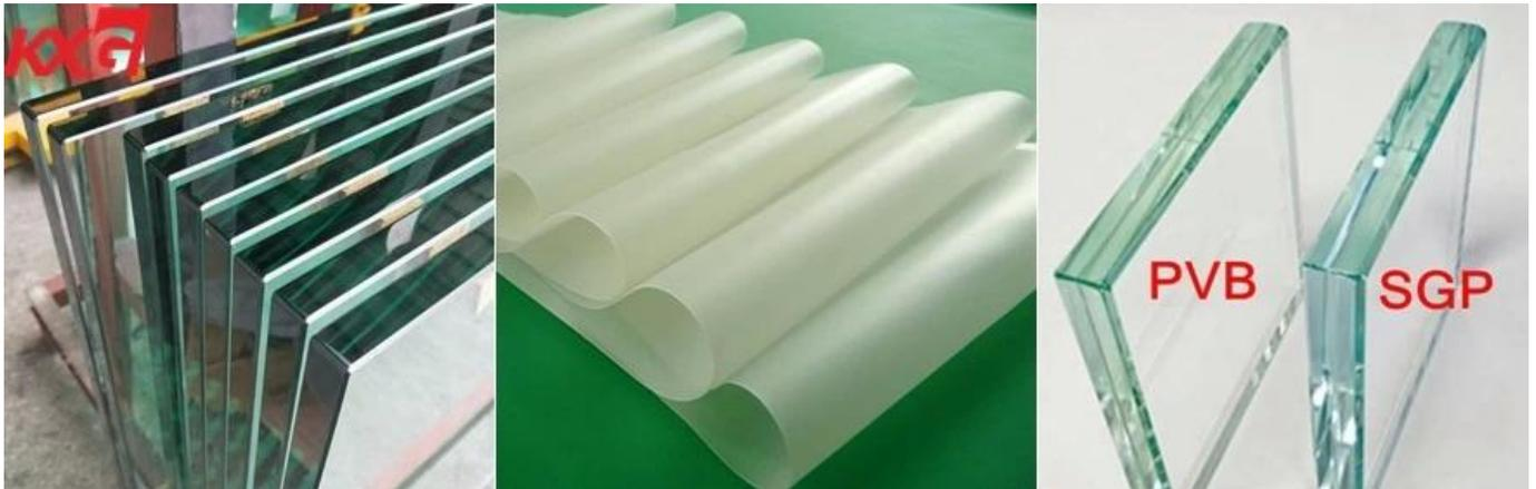
Excelente calidad 15 mm +1.52 mm PVB / SGP entre capas + 15 mm vidrio laminado templado, que se procesa con 2 piezas de 15 mm de vidrio templado transparente o ultra claro o coloreado con 1.52 mm PVB intercapa o SGP intercapa para unirlo. Que es un tipo de vidrio de seguridad que se mantiene unido cuando se rompe, se usa ampliamente en lugares donde existe la posibilidad de impacto humano o el vidrio podría caerse si se rompe, como balaustrada, claraboya, escaparate, piso, etc.
