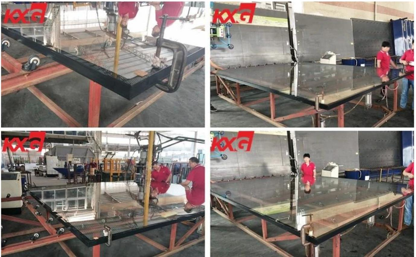
**Las ventajas del tamaño Jumbo de vidrio templado extra claro de 8 mm + espaciador de aire negro de 24 mm + vidrio aislante endurecido de bajo contenido de hierro de 8 mm**
