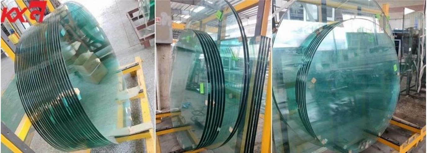
El vidrio endurecido se fabrica calentando el vidrio recocido a más de 600 ° C y enfriándolo rápidamente, que bloquea las superficies exteriores del vidrio en un estado de alta compresión, y el núcleo o centro del vidrio en tensión compensadora. El vidrio templado redondo transparente se usa ampliamente para la mesa o la mesa central, etc.
