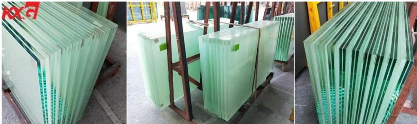
El vidrio laminado templado translúcido esmerilado mm 17.52 se puede fabricar con dos composiciones, una de vidrio templado esmerilado mm de una pieza de una pieza y vidrio templado transparente de mm de una pieza de 1.52, con una capa intermedia PVB incolora de 1.52 mm. La otra composición es dos piezas de vidrio templado incoloro 8 mm con 0.38 mm esmerilado PVB y 1.14 mm entre capas PVB transparente.
