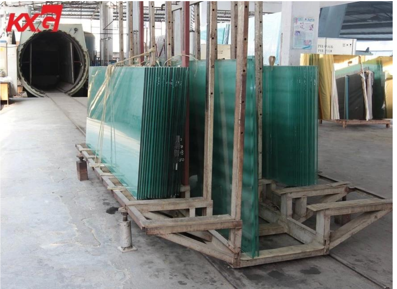
6 mm +0.76 mm PVB + 6 mm กระจกนิรภัย กระจกนิรภัย กระจกนิรภัย กระจกนิรภัย กระจกนิรภัย กระจกนิรภัย กระจกนิรภัย 8 กระจก
