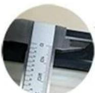
**Sufficient thickness $\geq$ 9mm**
