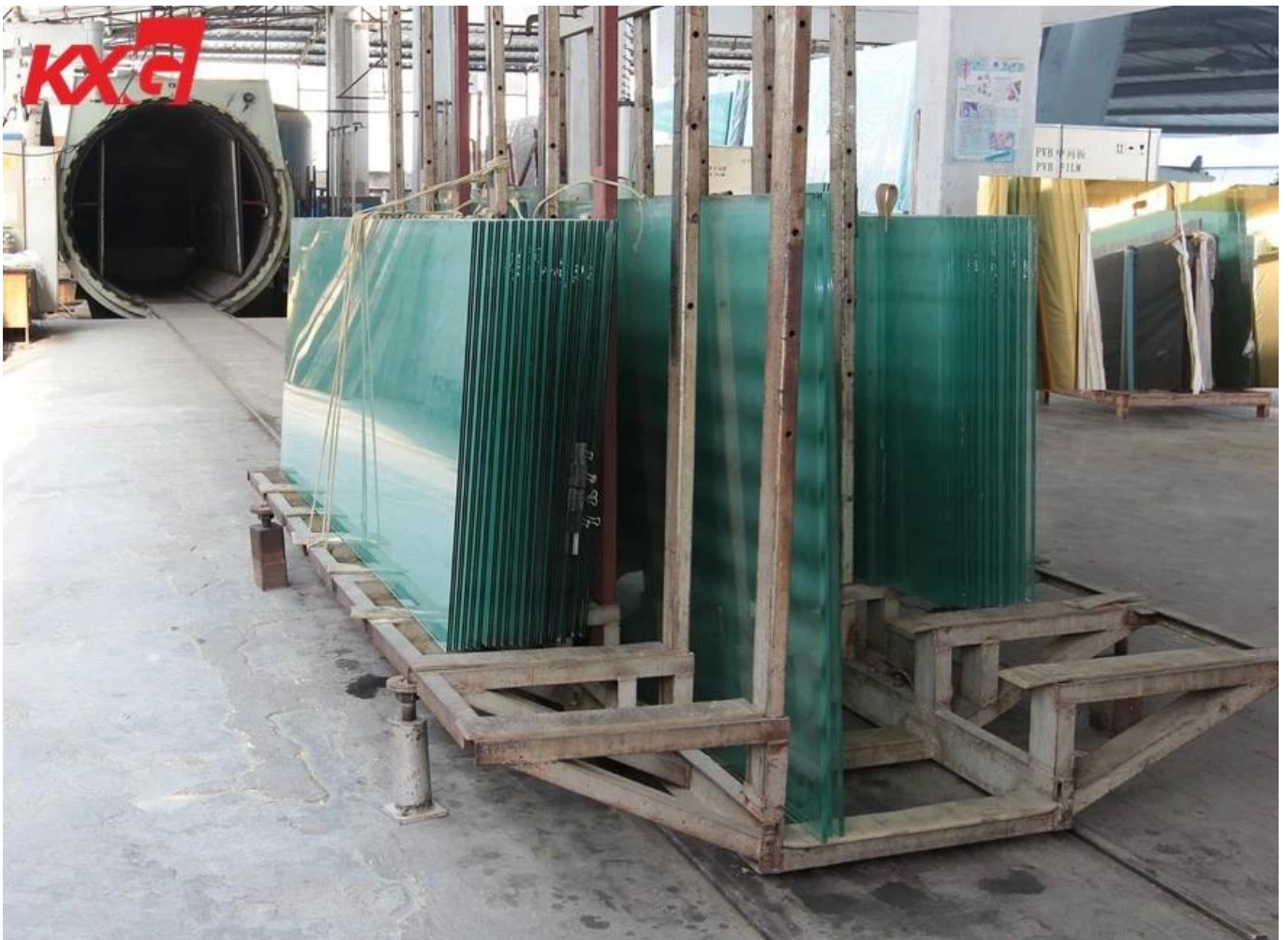
6 mm +0.76 mm PVB + 6 mm jelas laminating kaca tetap kekal autoklaf 8 jam
