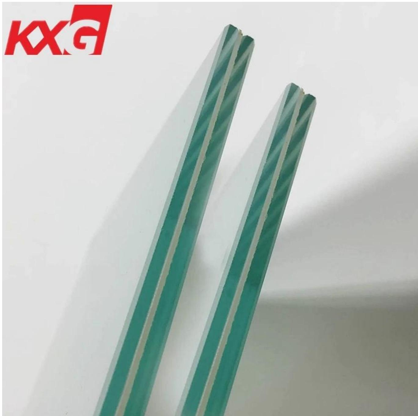
Pada masa yang sama, ia mengelakkan kerataan kaca tempered dan mudah meletup sendiri. Apabila kaca yang diperkuat dengan Panas pecah, radial itu pecah secara radial di sepanjang sumber retak, dan secara
