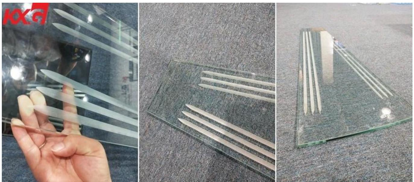
Dalam kedua-dua kes, kaca laminated toughened biasanya dipilih, untuk ketahanan dan ketahanan terhadap pecahnya. Syarikat kaca KXG menawarkan unit kaca bersalut SGP 1 "unit tebal, tiga lapisan laminasi: lapisan atas 12 mm tempered glass untuk rintangan hentaman + 12 mm kaca + 12 mm yang dikukuhkan oleh lapisan bawah kaca, yang diikat dengan interlayer SGP yang jelas.
