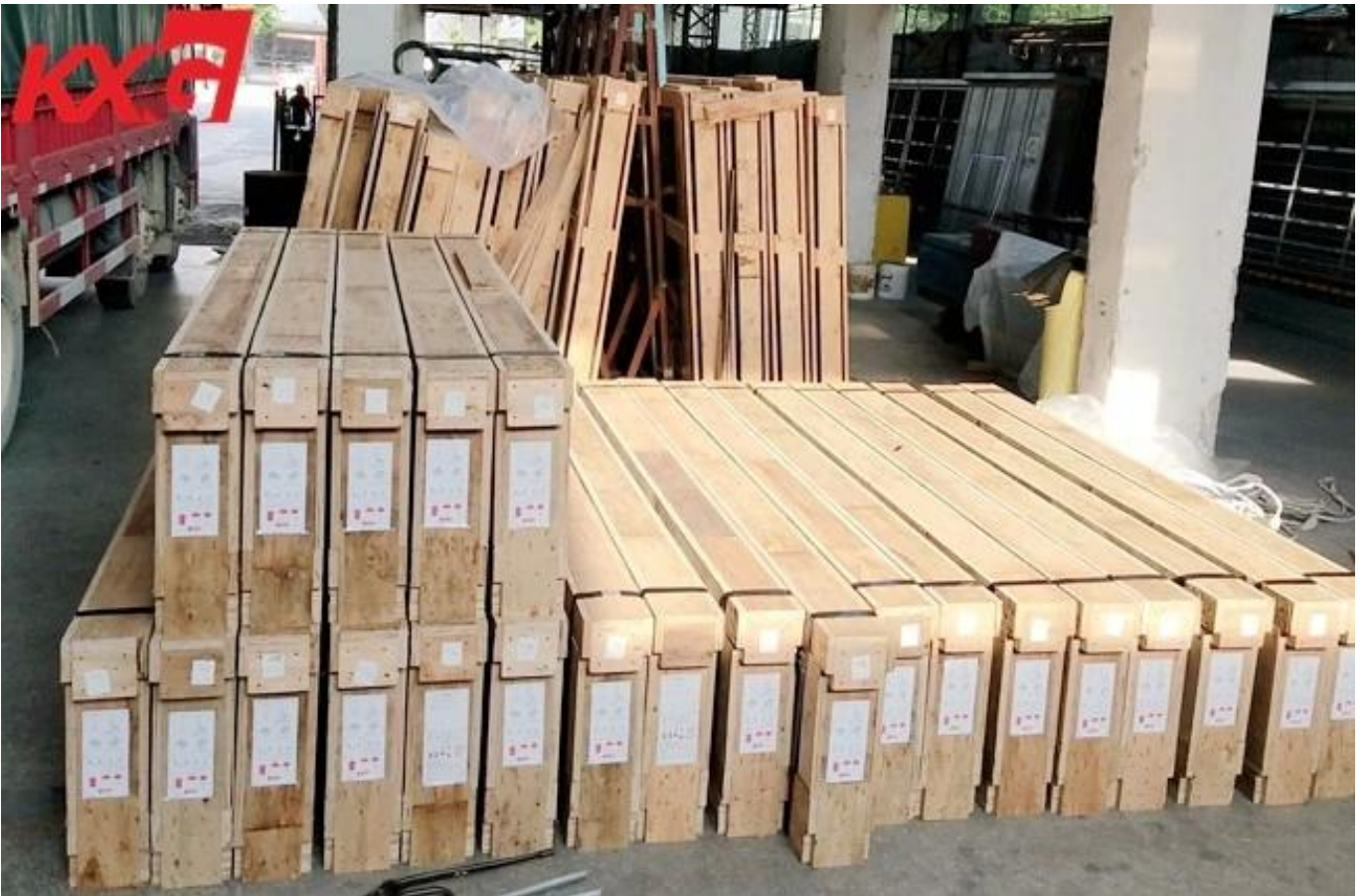
12 mm mababang bakal na tempered glass packaging sa pamamagitan ng plywood crate na may steel belt
