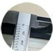
**Sufficient thickness $\geq$ 9mm**
