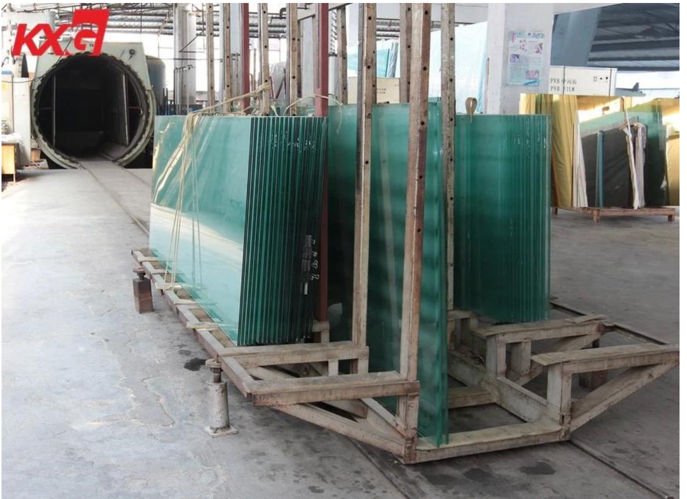
6 mm +0.76 mm PVB + 6 mm dhahiri kioo laminating kioo kukaa autoclave masaa 8
