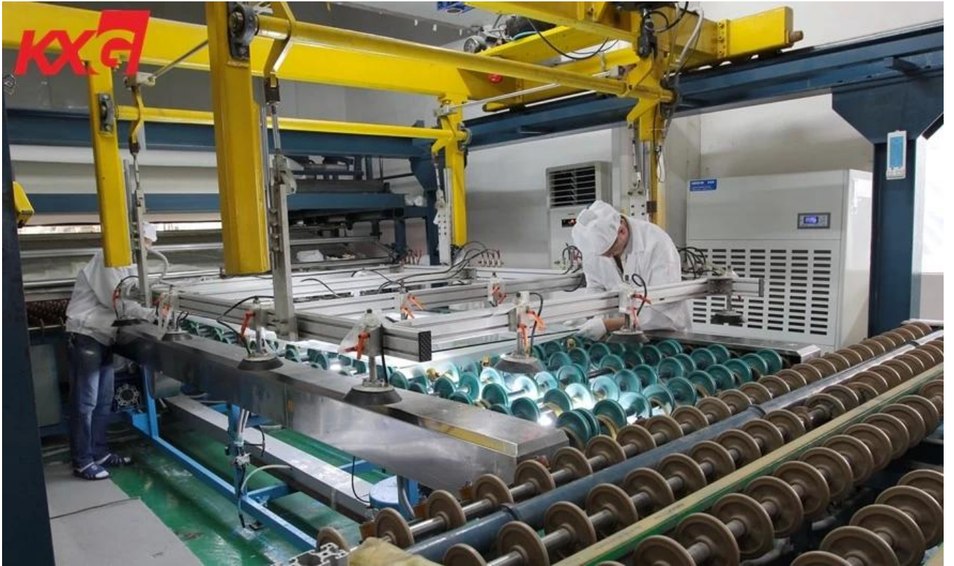
6 mm +0.76 mm PVB + 6 mm dhahiri kioo laminating kioo kukaa autoclave masaa 8
