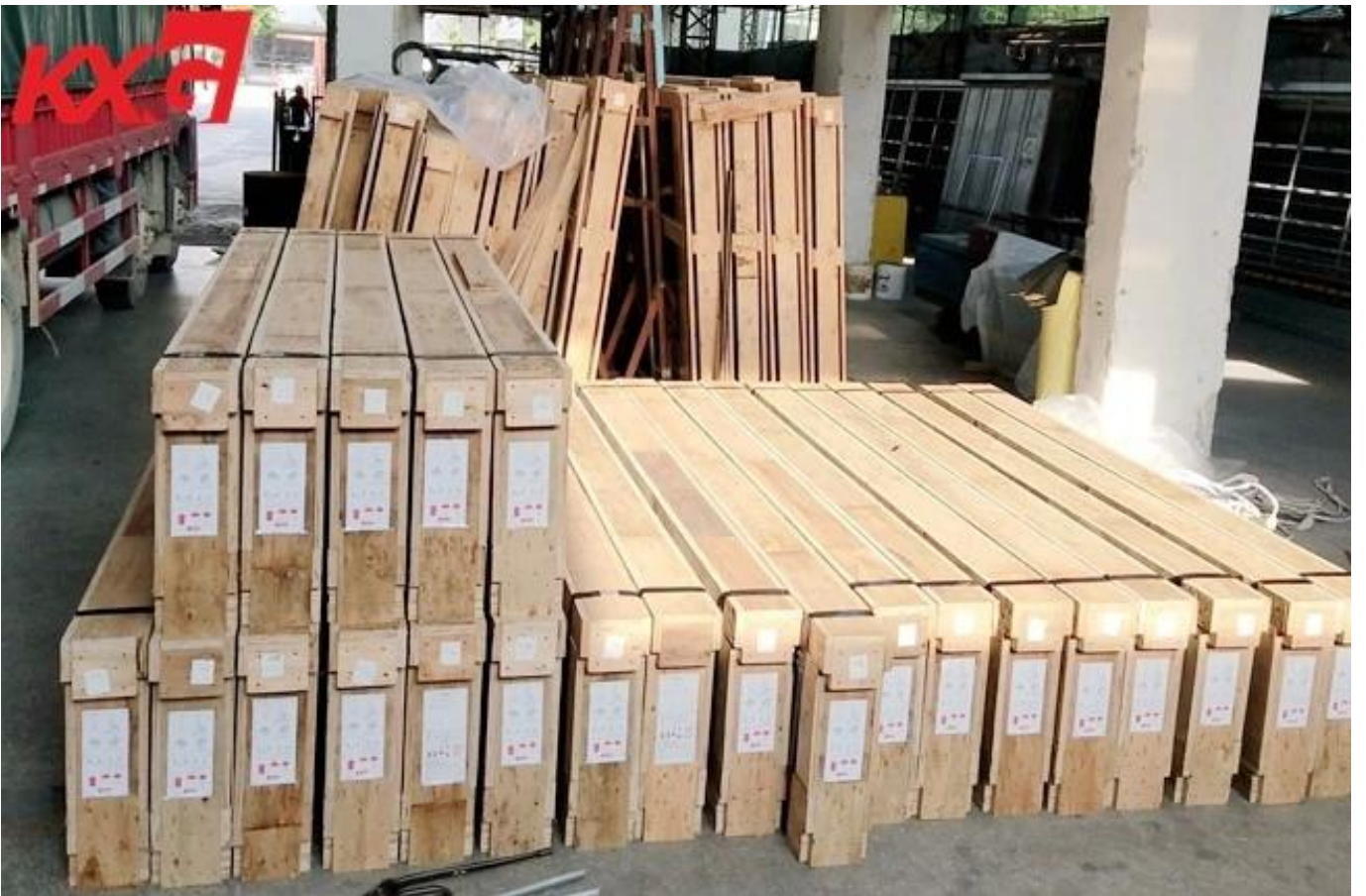
12 mm chuma cha chini cha moto kioo na kamba ya plywood yenye ukanda wa chuma
